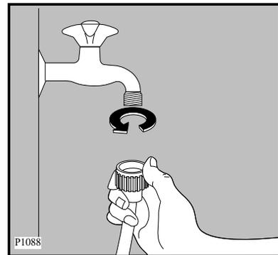
am Gerät und am Wasserhahn auf Dichtigkeit prüfen!
